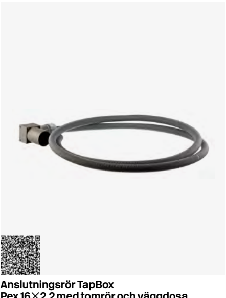
Anslutningsrör TapBox Pex 16x2,2 med tomrör och väggdosa. Längd 3 meter för dold rördragning från inbyggnadsblandare till taksil respektive handdush och / eller badkarspip. 1st per förpackning. Slangen är kapbar.
